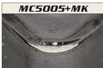
MC5005+MK 摩耗量 0.29mm 加工数 30 台
