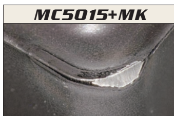
MC5015+MK 摩耗量 0.44mm 加工数 17 台
